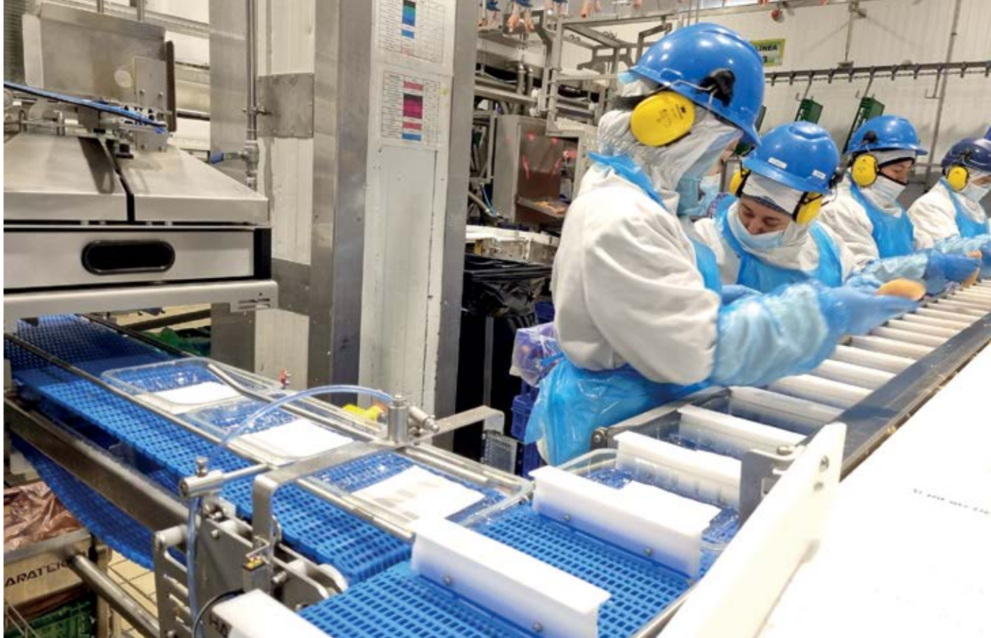
A la izquierda de la imagen se aprecia la tecnología que permite una dispensación automática de las bandejas para el pollo
