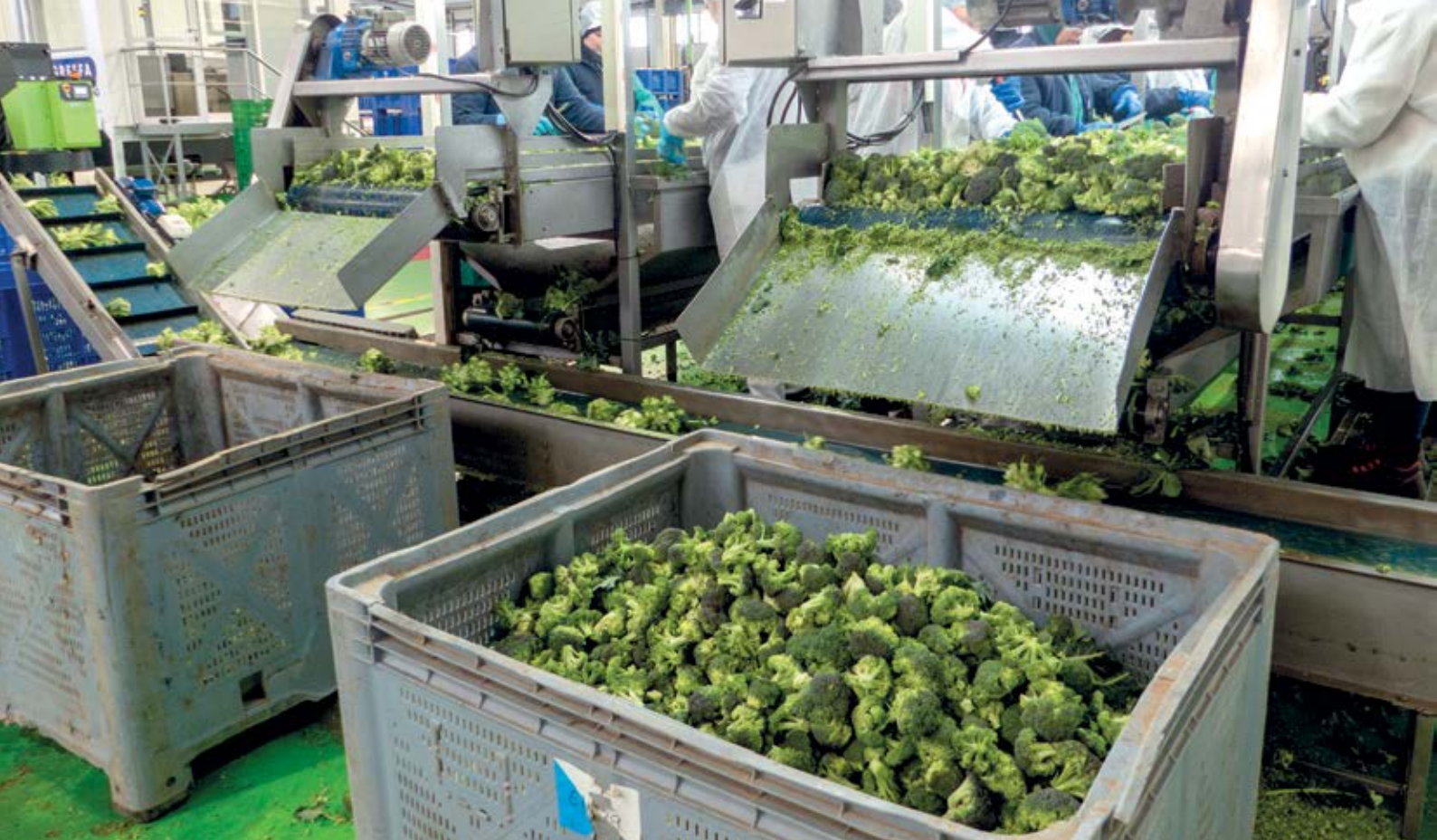
En la línea principal se pueden llegar a procesar 70.000 kilos en un turno completo
