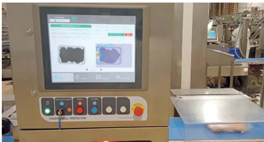
Entre las mejoras introducidas, la visión artificial, que realiza un filtrado de calidad adicional
