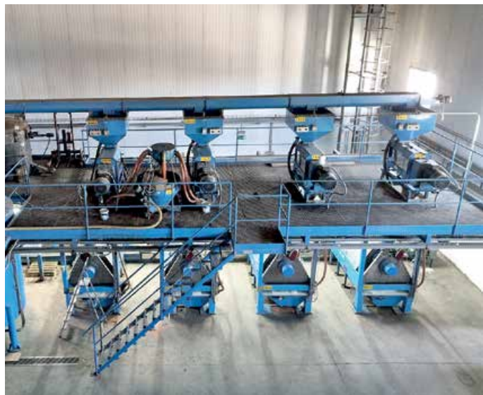
En la imagen del interior de la fábrica se aprecian las ocho prensas, cuatro arriba y cuatro abajo, que realizan la extrusión
